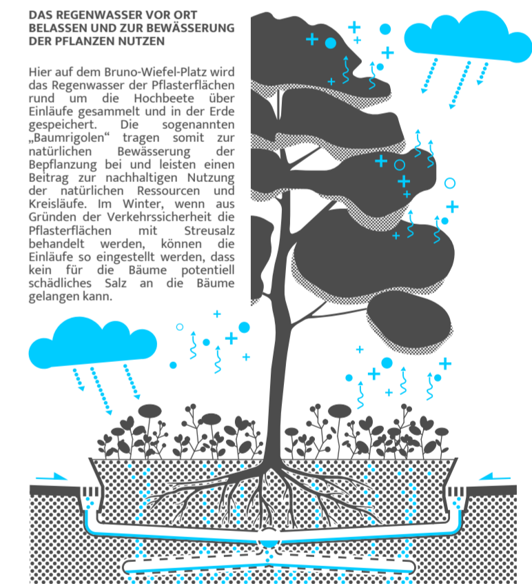
Schematische Darstellung einer Baumrigole
